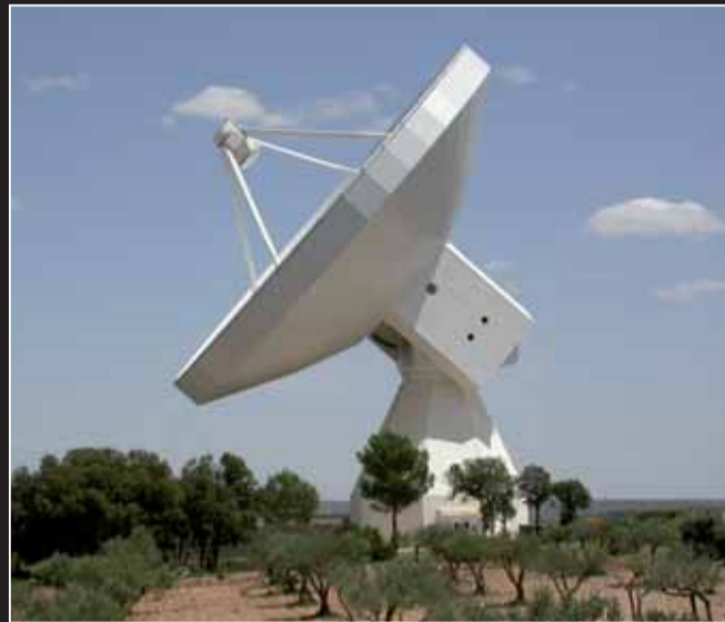
Radiotelescopio de 40 m de diámetro del OAN en el Centro Astronómico de Yebes (Guadalajara), de reciente construcción.
